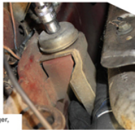
Dämpfer-Hitzeschutz in letzter Ausführung: über Konsole mit größeren Gummi montiert.
