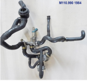
M110/M116/M117 Lage luftführender Gummiteile im schlecht sichtbaren Bereich unterhalb der Saugrohre
