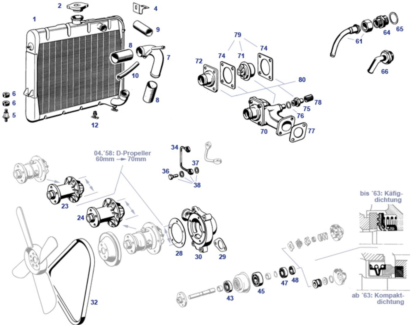
Die Bausituation lässt Montage abweichender Flügelräder zu, (z.B. 3-Loch, Ponton), mehr Info auf Seite 20.a "Wasserpumpen". Gebrauchte Waaskühler lassen sich mit neuem Kühlernetz aufarbeiten, sofern alle äußeren Gehäuseeile vorhanden sind und nicht zu stark beschädigt. Vorherige Einsendung Ihres Altteils ist erforderlich.
