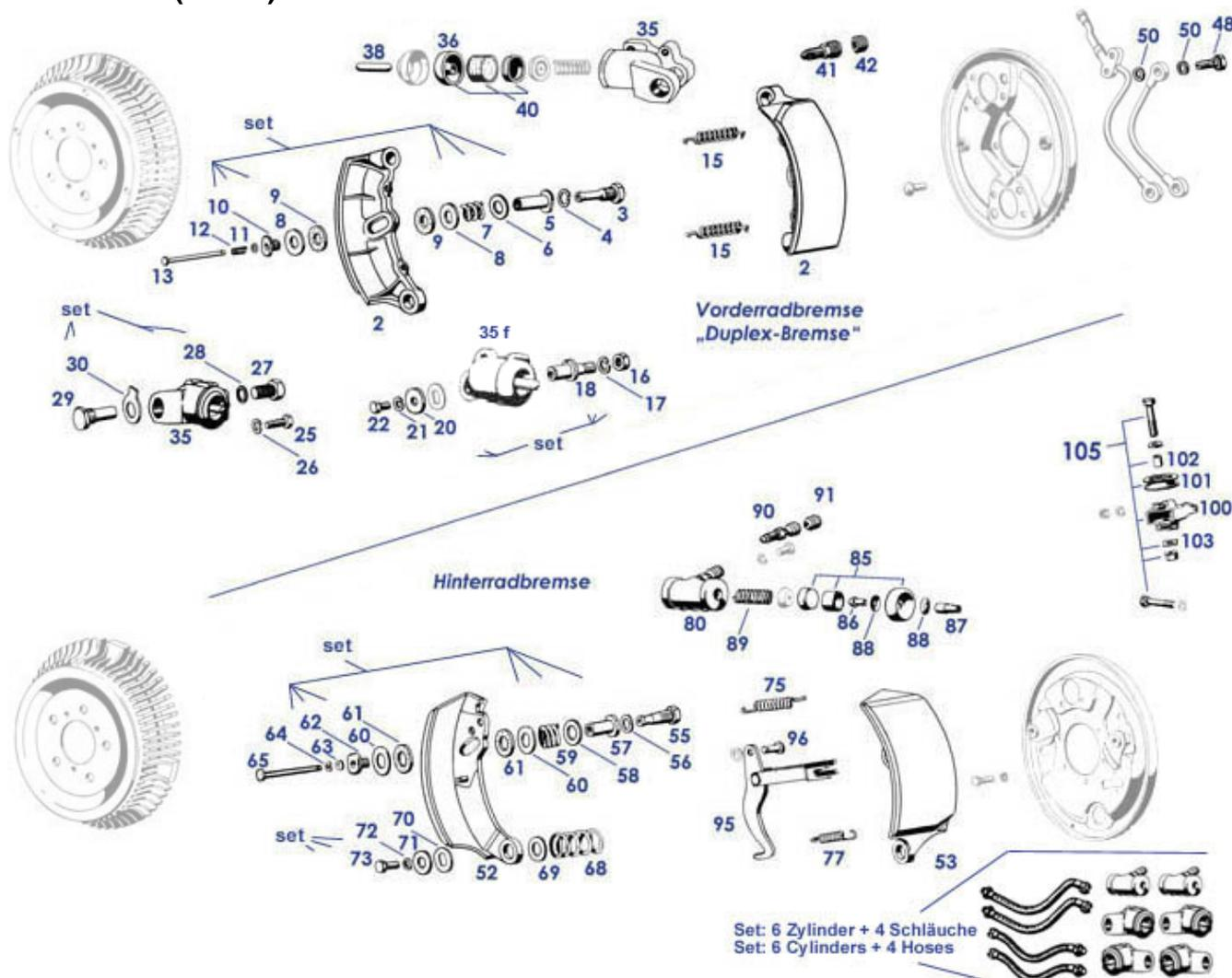
Fast ab Produktionsbeginn (ab Hinterachse 5500230) waren 190SL rundum mit gekühlten Trommeln ausgerüstet. Trommeln ohne Radialrippen können Hinweis auf eine Ponton-Achse sein, an der Hinterachse könnten in dem Fall schmalere Backen montiert/montierbar sein. Bremsschuhe hinten wurden ersetzt von der Bauart "W180" in die Bauart "W110", das sollte Achsweise geschehen (sein) und die Rückzugfedern müssen dazu passen. Zu Änderungsdetails an den vorderen Zylindern besuchen sie bitte Baugruppe 42.b.
