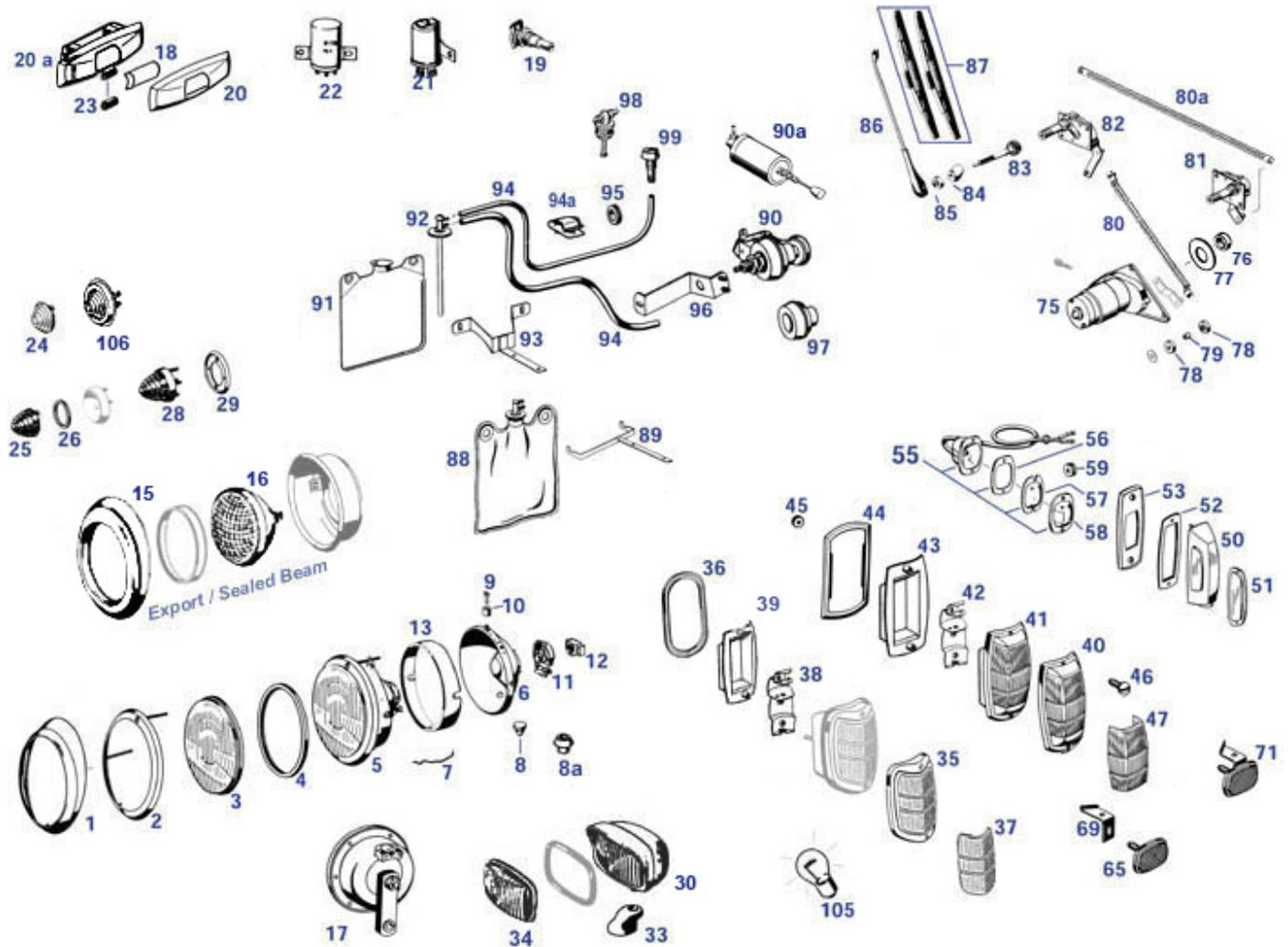
Beleuchtungs-Landesregeln: in den USA fahren 190SL bis heute mit symmetrischem Licht und Sealed-Beam Lampen (dadurch Chromzerring innen kleiner und Parkleuchte im Blinker). In Deutschland asymmetrisches Abblendlicht ab 7502150, andere Versionen müssen umgerüstet werden, weißes Blinklicht nicht zulässig.
