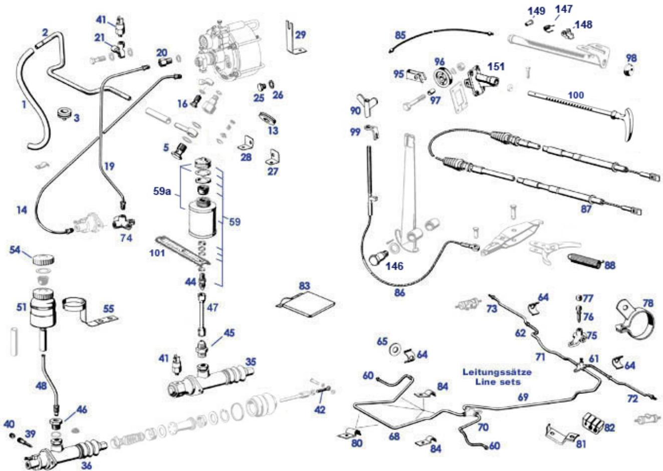
Die "Nachschaltung" des Bremskraftverstärkers T50 verlagerte die hydraulische Verteilung auf das Teil 74 im Bild, wodurch die Zuordnung der Hauptzylinder und Bremsleitungen von dieser Ausstattung abhängt. Der Kolbendurchmesser wurde dabei vergrößert.
