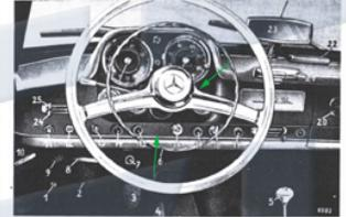
190SL haben meist 5 Schalterplätze links neben der Lenksäule und freie Bereiche unter der Lenksäule und neben der Tankanzeige (Bild: Ausf. 1958 m. Lenkschloss+Anlass-Druckknopf, ohne Zündversteller), eine Änderung der Schalteranordnung ist möglich, z.B. wenn durch Modifikation der Vergaser einer der Startzüge entfällt. Die Platzauswahl sollte keine neue Verletzungsgefahr für die Beine darstellen, ohne Risiko versehentlicher Betätigung/Beschädigung und im Sichtbereich angeordnet sein.
