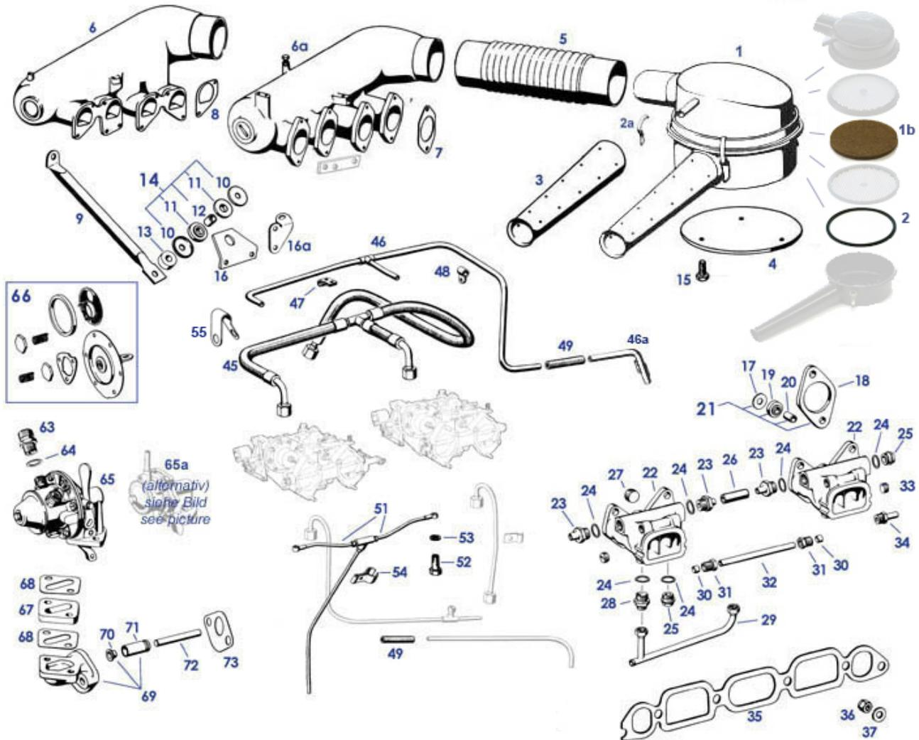
Saugrohr- und Vergasergehäuse sind ab Motornummer ..921-5500709 (09.'55) im Spritzgussverfahren gefertigt (Sandguss abgelöst), als Erkennungszeichen s. Kanalform Dichtungen 7+8 im Bild. Sind Sammelrohr und Filtergehäuse nicht vorhanden oder kürzlich neu montiert worden, besteht i.d.R. ein Zusammenhang mit Weber-Vergasern. In diesem Fall prüfen, ob die Umgebungsteile (Stütze Nr. 9, Kraftstoffleitungen, Saugkanäle mit Kanalübergang) zur Montagesituation passend montiert sind.
