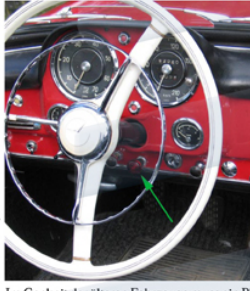
Knopfdesign bis 1967: W110 und frühe W111 und 113 hatten Cockpitschalter wie im Beispielfoto. Einen Warnblinkschalter in diesem Design gibt es z.Zt. nicht
