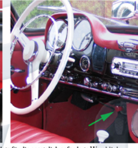
190SL haben meist 5 Schalterplätze links neben der Lenksäule und freie Bereiche unter der Lenksäule und neben der Tankanzeige (Bild: Ausf. 1958 m. Lenkschloss+Anlass-Druckknopf, ohne Zündversteller), eine Änderung der Schalteranordnung ist möglich, z.B. wenn durch Modifikation der Vergaser einer der Startzüge entfällt. Die Platzauswahl sollte keine neue Verletzungsgefahr für die Beine darstellen, ohne Risiko versehentlicher Betätigung/Beschädigung und im Sichtbereich angeordnet sein.
