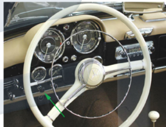
Hier wurde durch Umlegung des Heißstartzuges ein Platz für den zeitgenössischen Warnblinkschalter geschaffen.
