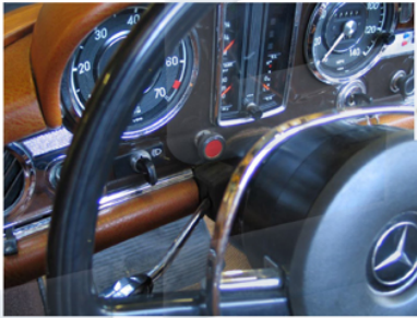
Knopfdesign bis 1967: W110 und frühe W111 und 113 hatten Cockpitschalter wie im Beispielfoto. Einen Warnblinkschalter in diesem Design gibt es z.Zt. nicht
