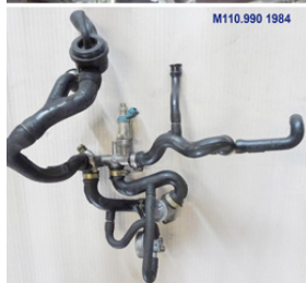
M110/M116/M117 Lage luftführender Gummiteile im schlecht sichtbaren Bereich unterhalb der Saugrohre
