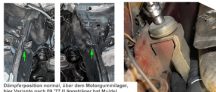
Dämpfer-Hitzeschutz in letzter Ausführung: über Konsole mit größeren Gummi montiert.
