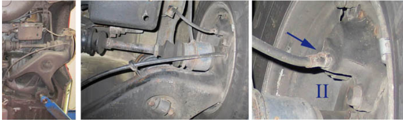
Bildreihe unten: Achse m. „Koppellenker“ (hier 500SL + 500SE). Bremsschlauch nicht direkt an Sattel , sondern Extraleitung zur Sattelposition vor der Achsmitte. Schnelle Erkennung: Lenker aus Leichtmetall mit auffälliger Wabenstruktur.
