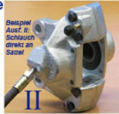
Bildreihe mitte: Hinterachse mit einfachem Lenker/Radträger (hier 300SL und 280SL), Bremssattel hinter Achsmitte mit seitlichem Anschluss. --> Bremsschlauch direkt an Sattel .
