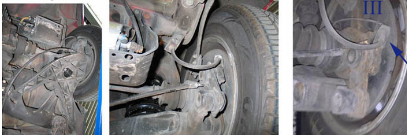
Bildreihe unten: Achse m. „Koppellenker“ (hier 500SL + 500SE). Bremsschlauch nicht direkt an Sattel , sondern Extraleitung zur Sattelposition vor der Achsmitte. Schnelle Erkennung: Lenker aus Leichtmetall mit auffälliger Wabenstruktur.
