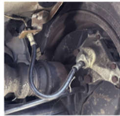
Schräglenker Gen.III, populärste Variante: Schläuche direkt an Sätteln, Verteiler+Leitungen am Querträger
