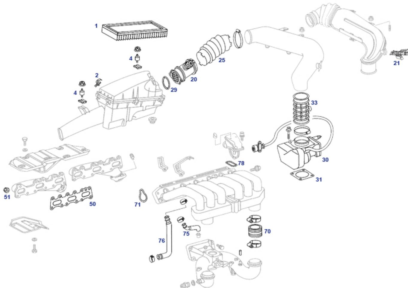
Luftfilter bis Saugrohr für Typen 129.058 und 129.063: ab Einsatz Heizdrahtmessung (1993) bis Ende der Reihen-Sechszylinder (1998)
